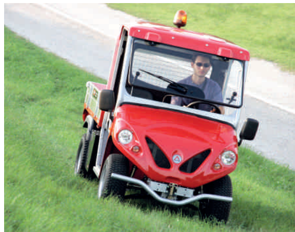
AXT-Pritschenwagen, bis zu 600 kg Nutzlast, 8 PS, max. 70 km Reichweite.
