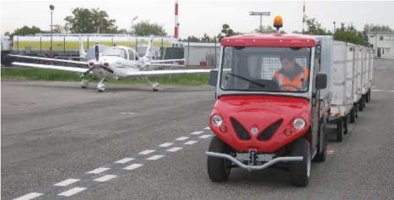
Elektrokarren: elektrische Zugfahrzeuge mit einem unabhängigen Betrieb von bis zu 130 km Elektrokarren Alkè mit Warenanhängern für Bahnhöfen und Flughäfen
