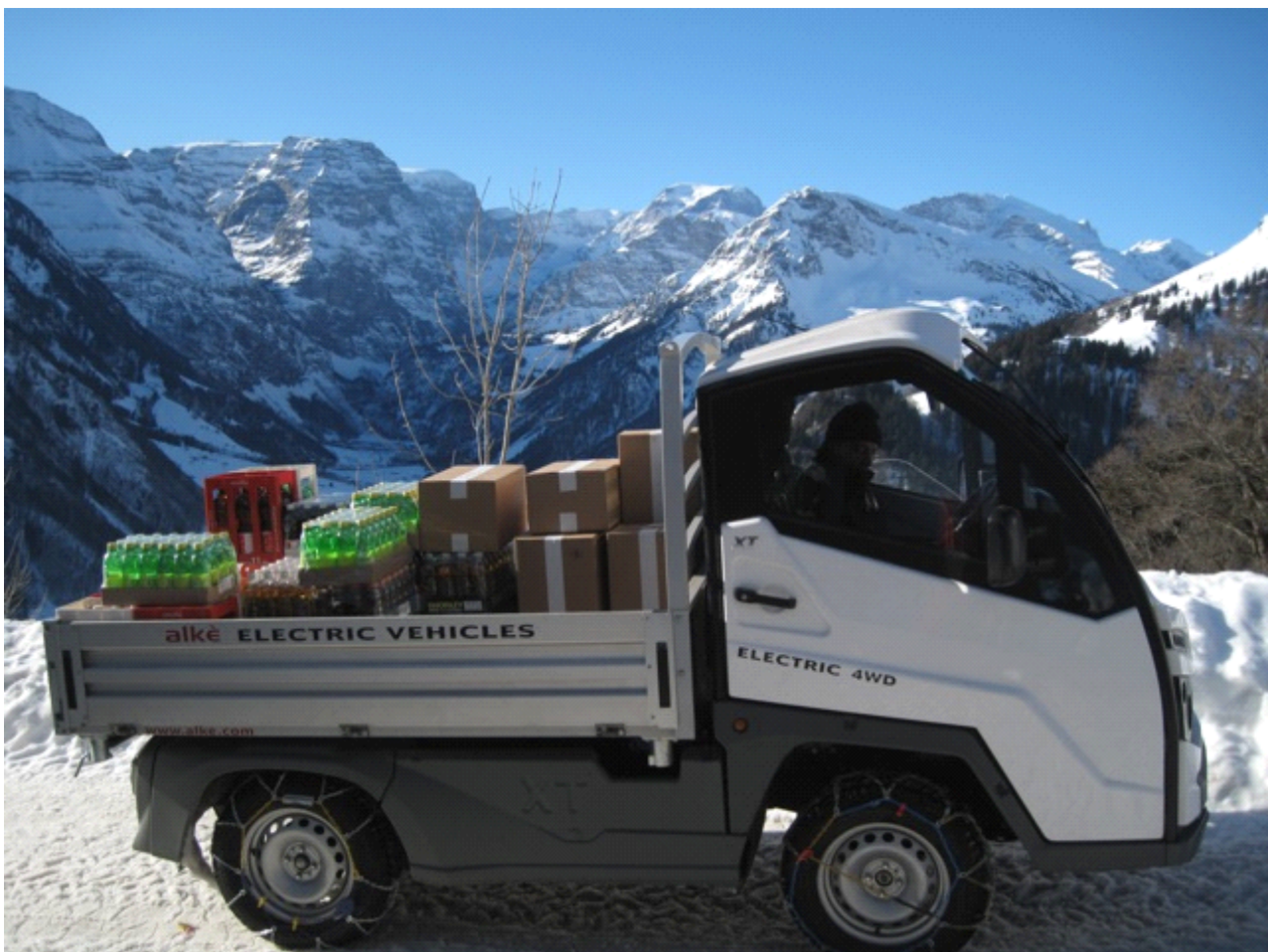
Mit den Elektro-Lastwagen sind schnelle Starts auch auf Rampen mit starkem Gefälle möglich. Die Elektro-Lastwagen Alke' reduzieren die Verbräuche um 30 % mit der Energierückgewinnung beim Bremsen
